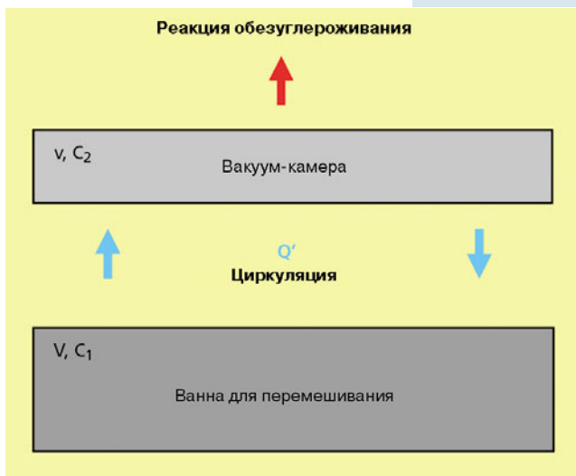
Рис. 3. Модель обработки стали в двух емкостях с ванной для перемешивания
