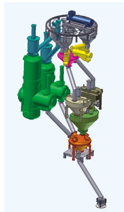
Рис. 4. Система внесения легирующих под вакуумом с двухкамерным вакуумным шлюзом, двумя вакуумными бункерами и тремя бункерами для микролегирующих добавок
